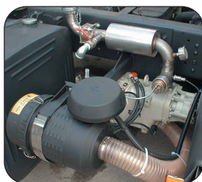
Cmax 2 S napędzany wałkiem
